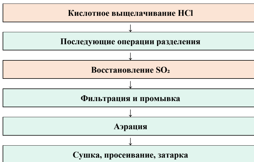
Рис. 2. Предлагаемая технологическая схема \text{HCl}/\text{SO}_2
