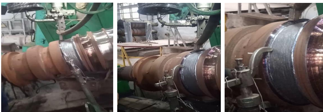
1-rasm. Tayyorlov stani valoklariga sim qoplama bilan ishlov berish jarayoni
