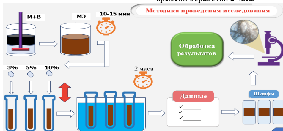
Рис. 1. Методика проведения исследования процесса обезвоживания отработанного масла с применением деэмульгатора «КХД-М-1»
