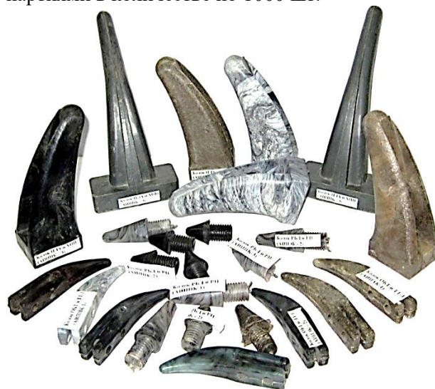
Рис. 3. Отлитые детали из антифрикционных и антифрикционно-износостойких композиционных полипропиленовых полимерных материалов рабочих органов хлопкоперерабатывающих машин
