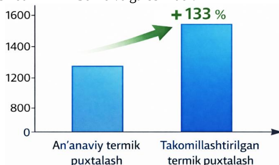
3-rasm. Jo'valar xizmat muddati va termik puxtalash texnologiyasi o'rtasidagi bog'liqlik
