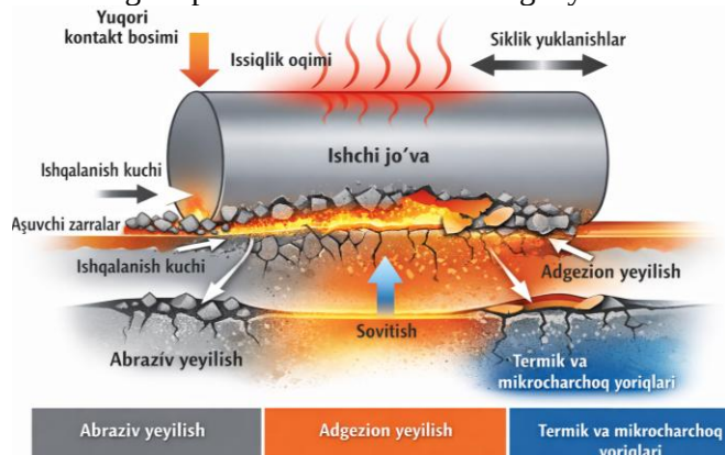
1-rasm. Prokatlash jo'valarida ekspluatatsion yuklanishlar va yeyilish mexanizmlari
