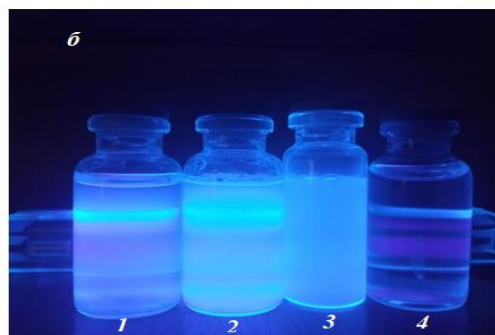
1-расм. Олинган намуналар оддий шароитдаги (а) ва ультрабинафша нур (б) таъсирида олинган оптик тасвирлари. (1.MIP@CdTe + FF, 2.MIP@CdTe, 3. HIP@CdTe ва 4.Дистилланган сув)
