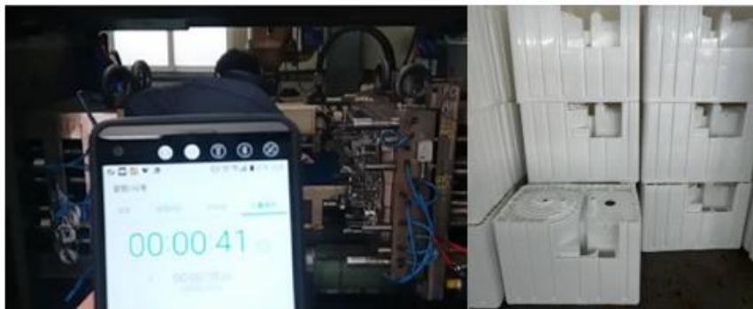
8-рasm. Yangi konform sovutish kanaliga ega bo'lgan qolip bilan qoliplash jarayonini testdan o'tkazish.
