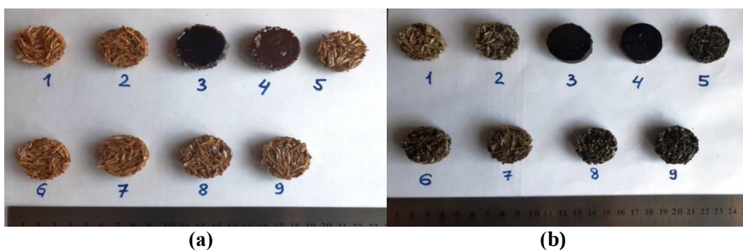
Рис. 1. Фотографии экспериментальных образцов на основе рисовой лузги для проведения испытаний по определению коэффициента звукопоглощения и звукоизоляции: группа образцов из композитов, модифицированных монтмориллонитом (а); группа образцов из композитов, модифицированных углеродными нанотрубками (б)
