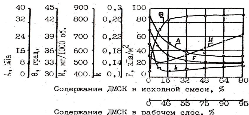
Рис.1, Зависимость контактного угла смачивания ( \theta ), коэффициента трения ( \kappa ), потери массы при износе ( \text{И} ), адгезионной прочности ( \text{А} ), удерживающей силы сцепления ( \text{F} ) эпоксиддиметилсилоксановых полимеров от содержания силоксанового компонента.
