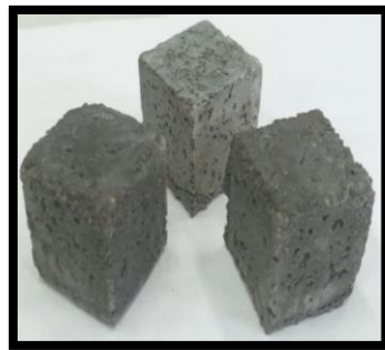
Рис.1 Образцы-кубы размером 2х2х2 см из цементно-песчаных растворов состава 1:3, твердевших в течение 3 мес. а) в H 2 O; б) в 3%-ном растворе Na 2 SO 4 ; в) в 1%-ном растворе MgSO 4
