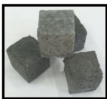
Рис.1 Образцы-кубы размером 2х2х2 см из цементно-песчаных растворов состава 1:3, твердевших в течение 3 мес. а) в H 2 O; б) в 3%-ном растворе Na 2 SO 4 ; в) в 1%-ном растворе MgSO 4
