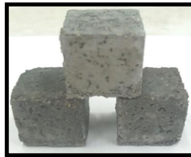
Рис.1 Образцы-кубы размером 2х2х2 см из цементно-песчаных растворов состава 1:3, твердевших в течение 3 мес. а) в H 2 O; б) в 3%-ном растворе Na 2 SO 4 ; в) в 1%-ном растворе MgSO 4
