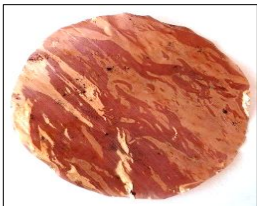
Рис.2. Оптический (а) и электронный (б) снимки in situ композита «целлюлоза - политиофен»
