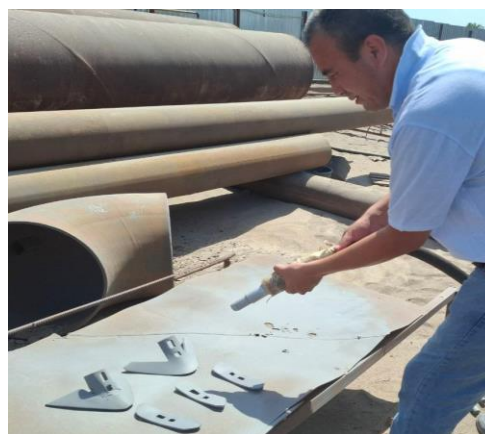
Рис.2. Абразивно-струйной обработки поверхности деталей
