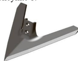
Рис.6. Заточенные лезвия лап после оплавления (Готовая продукция)
