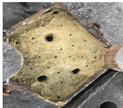
2–rasm. 3D modellar yordamida suyuq shisha bog'lovchi gil sifatida va CO 2 gazi yordamida qotirib olingan qoliqlar
