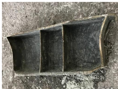
3 – rasm. Suyuq shisha bog'lovchi sifatida va CO 2 gazida qotirib tayyorlangan qoliqlarda ko'tarma shiber detallarini olish jarayoni
