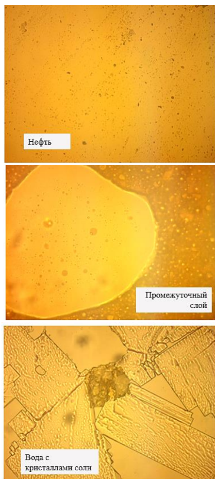
Рис. 4 – Снимки шлифов водонефтяной эмульсии 30%, (20-кратное увеличение) при температуре разделения 50°C.
