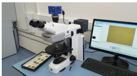
Рис. 1 – Рабочее место для наблюдения шлифов под микроскопом и получения их снимков
