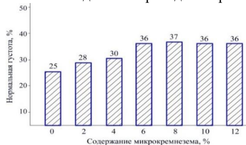
Рис. 2. Изменение нормальной густоты композиционных вяжущих от содержания микрокремнезема
