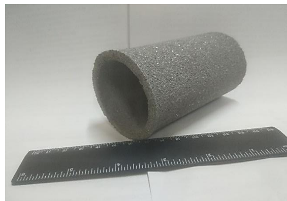
Рис.2 Фильтрующий элемент из высоколегированной стали марки ПХ18Н9Т полученным методом порошковой металлургии
