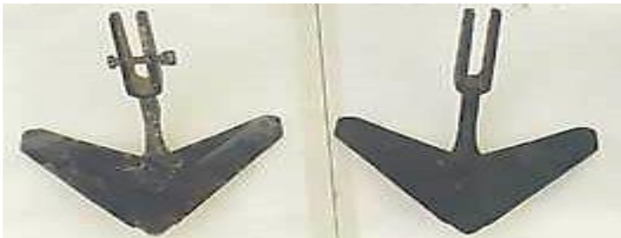
4- расм. Тошкент вилояти, Янгийўл тумани “Ниёзбош” ДФХ ўтказилган синовда культиваторнинг найзали панжарасини 40-45 Га ерга ишлов бергандан яроқсиз ҳолатга келган тасвири
