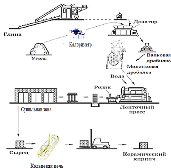
Рис.2. Усовершенствованная технологическая схема производства керамического кирпича
