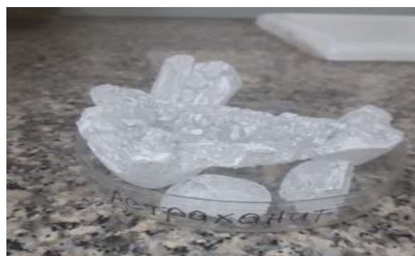
2-Rasm. Labaratoriyada maqbul sharoitda (50 °C) da Na_2SO_4 va MgSO_4 tuzlaridan sintez qilingan va kristallari o'stirilgan astraxanitni ko'rinishi
