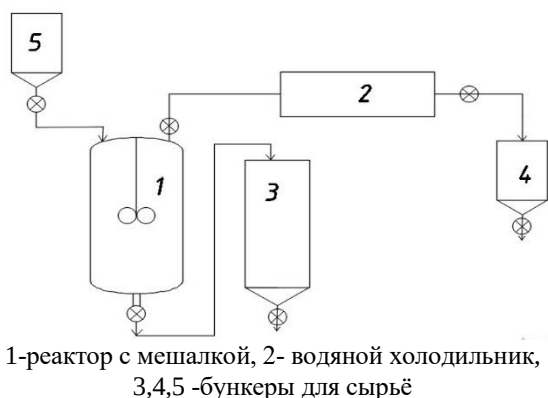
Рисунок 1. Технологическая схема получения кубового остатка газопиролизной смолы
