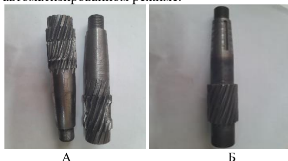
Рис.2. Вал-шестерня редуктора марки 1ЦУ-160. А- изношенный вал-шестерня из легированной стали ст. 40Х и Б - восстановленный из высоколегированной стали марки ПХ18Н9Т с термической обработкой-цементации
