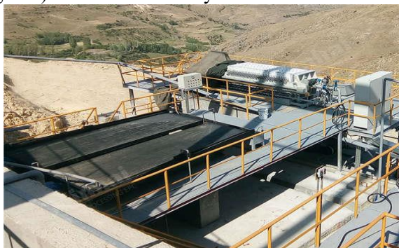
1-rasm. Volframitni gravitatsiya usulda boyitish texnologiyasi
