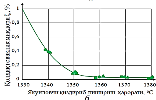
1 – 90%WC+6%Co+4%TiC; 2 – VK6 (стандарт) 3.9 – расм. Намуналарнинг якуний ҳароратга боғлиқ равишда (а) зичланиш даражасини ва (б) қолдиқ ғоваклигини ўзгариши графиги
