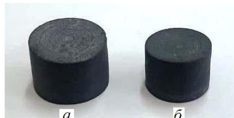
а – бирламчи ва б – якунловчи қиздириб пишириш жараёнидан 15% қисқарган 3.8 – расм. Қиздириб пиширилган намуналар
