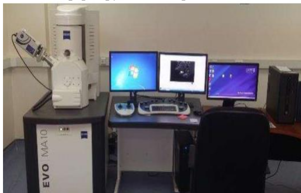
Рис.1. Сканирующий электронный микроскоп (SEM-EDX) марки Zeiss EVO MA 10/AztecEnergyAdvanced X-Act, производства Zeiss SMT LTD/OxfordInstruments (Великобритания)
