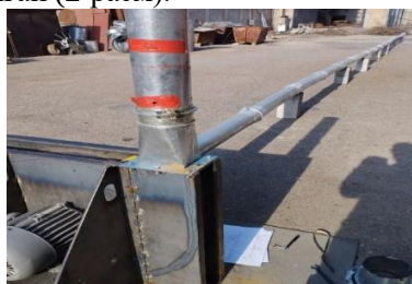
1-расм. 26 м қувурлар тизимига эга бўлган пневмотранспорт
