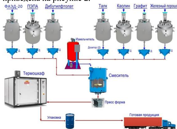
Рис.2. Технологическая линия производства термореактивных композиционных полимерных материалов на основе ФАЭД-20 с высокими электро-теплофизическими и антифрикционно-прочностными свойствами
