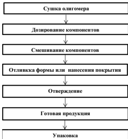
Рис. 1. Технологическая схема важнейших стадий получения композиционных, фурано-эпоксидных полимерных материалов и покрытий на их основе
