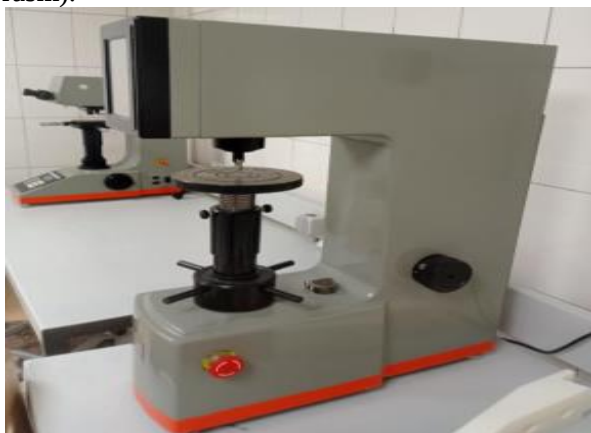
2-rasm. ITV-1-M markali qattqlikni o'lchovchi qurilma
