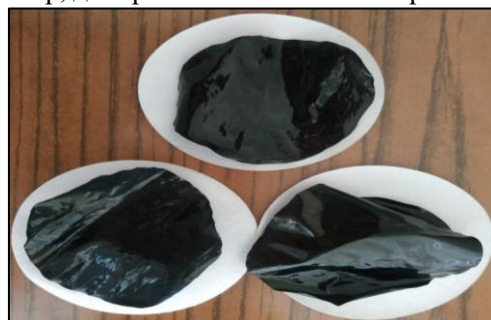
Рис.1. Оптические фотографии композита АЦ/ППир, полученного in situ полимеризацией пиррола в присутствии подложки из пористой целлюлозы
