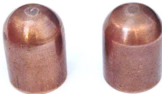
1-расм. Мис асосли материаллардан тайёрланган электродлар
