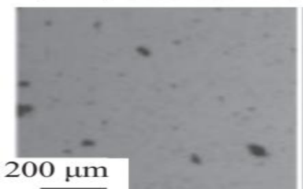
1-расм. Гидротозаланган присадкасиз ва присадкали дизел ёқилғисининг оптик микроскопда кўриниши
