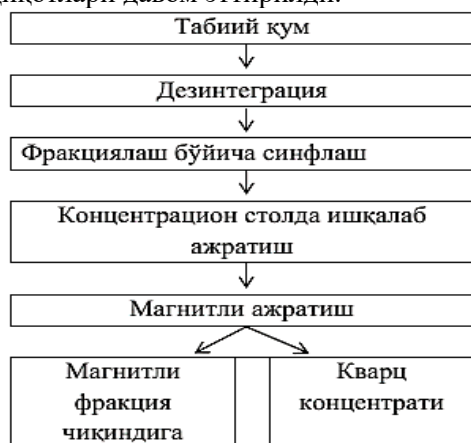
6-Расм. Кўкаёз кварц куми бошланғич хомашё намунасини бойитишнинг блок схемаси
