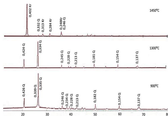
7- Расм. Бойитилиб юқори ҳароратларда қуйдирилган Кўкаёз кварц куми намуналарининг рентгенограммалари
