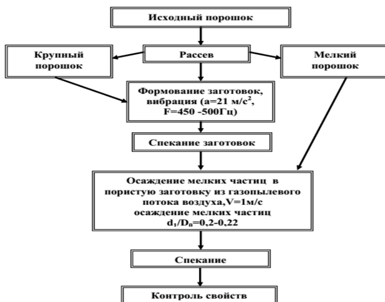
Рис.1. Схема технологического процесса изготовления фильтрующих элементов для очистки моторного масла автомобиля марки ISUZU методом осаждения частиц в пористую заготовку из газопылевого потока воздуха
