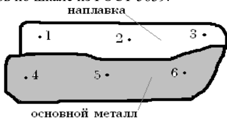
Рис.5. Схема замера твердости
