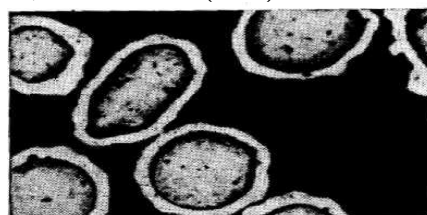
Рис.2. Частицы плакированного порошка, состоящего из никеля (85%) и графита (15%)
