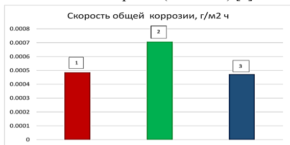
Рис.2. Скорость общей коррозии биметалла сталь-медь
