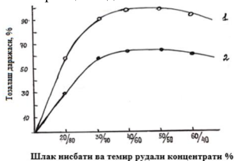
2-расм. Адсорбентдаги РШ ва те-мир концентратининг миқдорий нисбатига қараб нефт маҳсулотла-рини тозалаш самарадорлигига магнит майдонининг таъсири: 1-магнит майдон таъсирида; 2- магнит майдон таъсирисиз
