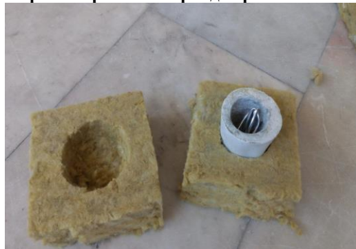
3-расм. Тигелни базалтли пахта ичига жойлаштирилган ҳолати
