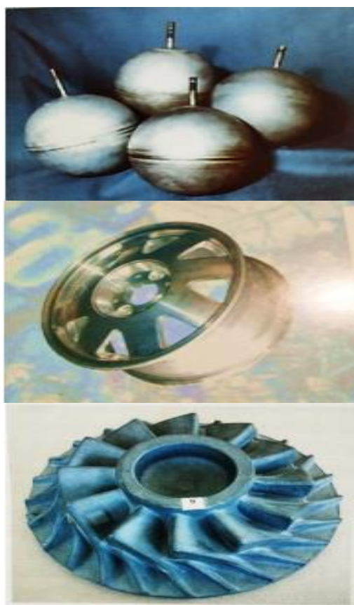
Рис.1. Детали полученные штамповкой в условиях сверхпластичности.
