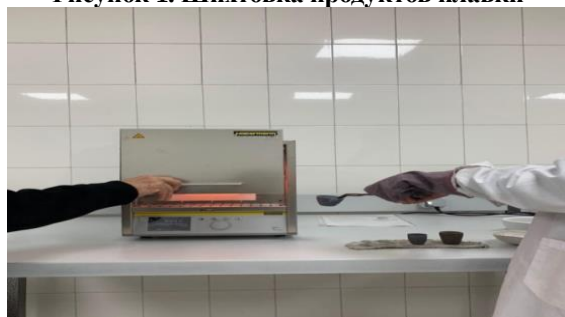
Рис. 2. Загрузка тиглей шихты в печь. Электрическая печь Nabertherm (Германия). Максимальная температура 1550 °C
