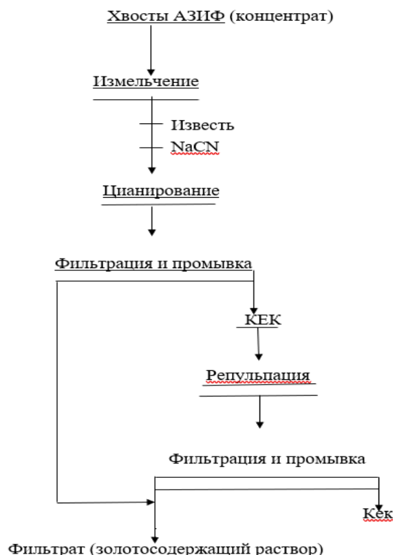
Рис. 1 Схема цианирования проб исходных хвостов из хвостохранилища Ангренской ЗИФ
