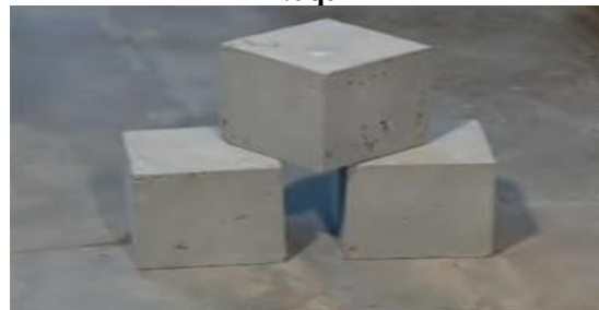
4-rasm. Superplastifikator qo'shilgan beton kublarning namunalari
